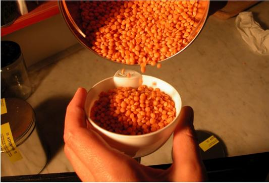
Bei der dagografischen Apparatur besteht die Fotoplatte aus zwei Scheiben, die mit 6 mm Abstand in einen Rahmen montiert sind. In der Dunkelkammer werden mit Hilfe eines Trichters fotosensible Linsen in diesen Zwischenraum gefüllt.
