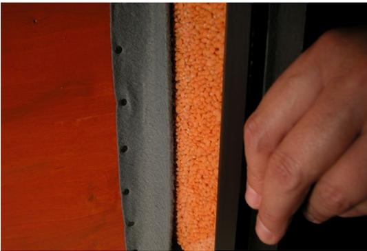
Die mit fotosensiblen Linsen vorbereitete Platte wird nun, immer noch in der Dunkelkammer, sorgfältig in den seitlichen Schlitz der Kamera eingeführt. Der Filzstreifen, der entlang dieser Öffnung angebracht ist, sorgt für einen lichtdichten Verschluss.
