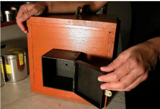
Nun bringt man die Kamera vor dem Objekt in Position und öffnet die vordere Klappe. Die Belichtungszeit beträgt je nach Distanz zum Objekt und Helligkeit 8–14 Minuten. Während dieser Zeit verfärben sich die Linsen je nach Intensität des Lichtes, das auf sie trifft. Nach erfolgter Belichtung schließt man die Klappe wieder.
